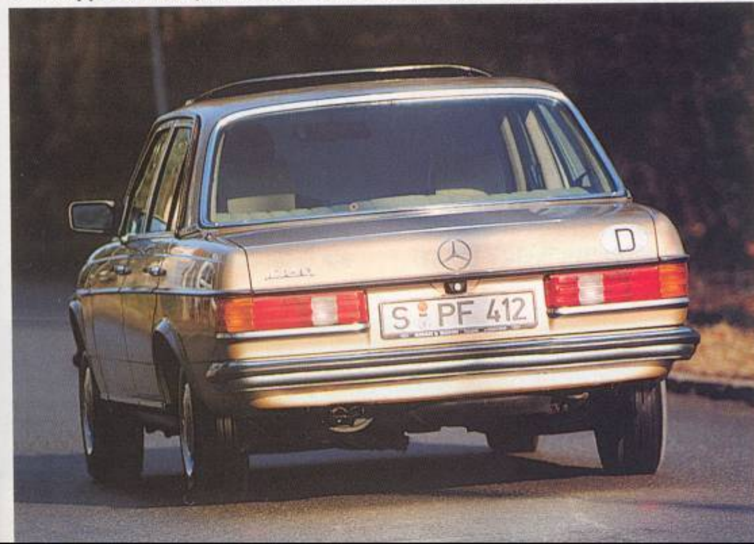
Der Doppelrohrauspuff kennzeichnet die 140-PS-Variante des 250
